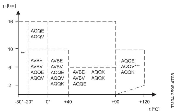
**Рис. 9** График подбора торцевых уплотнений
