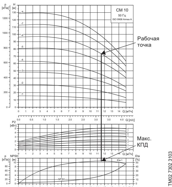
Рис. 28 Пример рабочей точки насоса СМ
