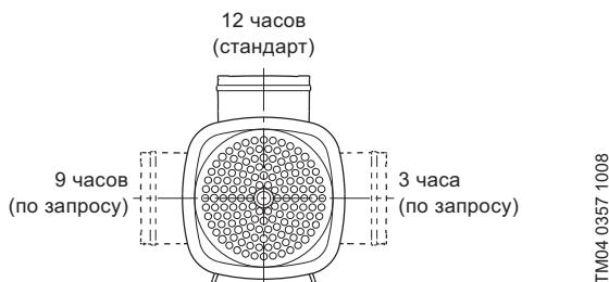
Рис. 12 Расположение клеммной коробки
