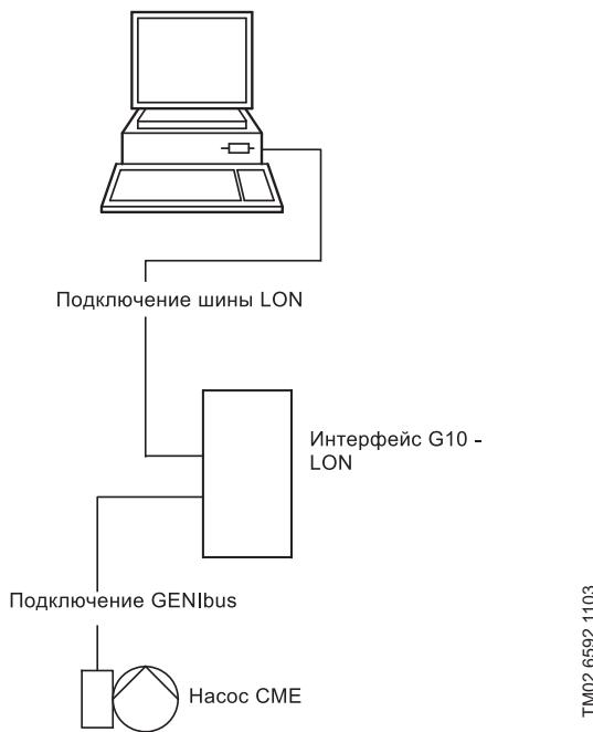
Рис. 18 Структура централизованной системы диспетчеризации здания
