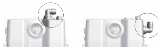
Рис. 16 Горизонтальное или вертикальное расположение напорного патрубка
