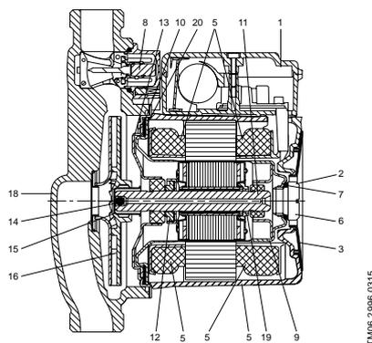
Рис. 84 Разрез насосов UPA 15-90, UPA 15-120
