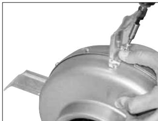
3. Die Halterungen mit den selbstbohrenden Schrauben festschrauben (Vorbohren nicht notwendig).
